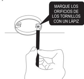
Use el anillo de la base de montaje para marcar los orificios de los tornillos en el techo o la pared.
