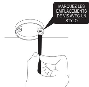
Utilisez le socle de montage pour marquer les emplacements des vis au plafond.
