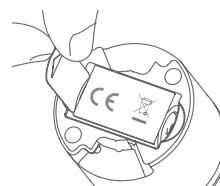
**3. Dopo il montaggio, testare il rilevatore premendo il pulsante di test sul lato: verrà emesso un suono forte.**
