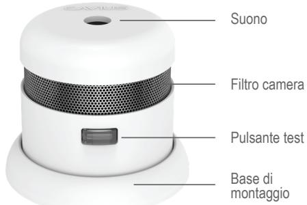
**Manutenzione:** Il rilevatore di fumo deve essere aspirato una volta ogni tre mesi e può essere pulito con un panno umido. (Non aprire il rilevatore). Testare il rilevatore almeno una volta ogni tre mesi premendo il pulsante di test. Il rilevatore eseguirà un test automatico ed emetterà un suono forte.
