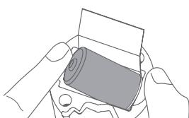
**Sostituzione di batteria:** Per sostituire la batteria staccare il rilevatore dalla base di montaggio ruotandolo in senso antiorario.
