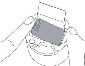
**Sustitución de la batería:** Para sustituir la batería, desencaje el detector de humo de la base de montaje girándolo en sentido contrario al de las agujas del reloj. Sustituya la batería respetando su polaridad.
