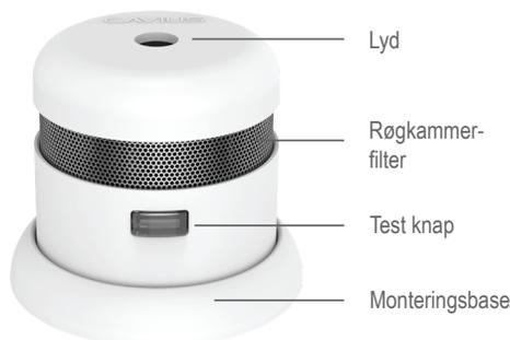
**Vedligehold:** Røgalarmer bør støvsuges én gang i kvartalet, og kan tørres af med en fugtig klud. (Åben aldrig alarmer). Test alarmer mindst én gang i kvartalet, ved at trykke på testknappen. Alarmer laver en selvtest og udsender en høj alarmtone.
