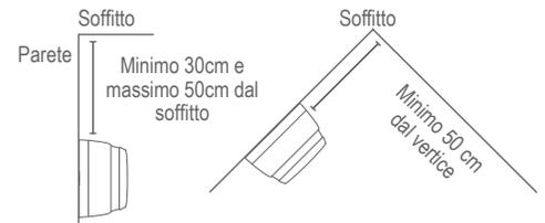
Con un minimo di un rilevatore di fumo per piano e una distanza massima tra rilevatori di fumo di 10 metri.
