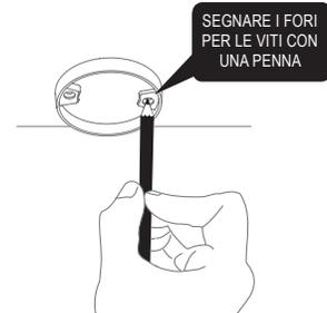
Utilizzare l'anello della base di montaggio per contrassegnare i fori per le viti sul soffitto o sulla parete.
