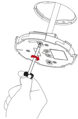
NOTA: No se usa base de montaje cuando el detector se instala sobre una caja de derivación.
