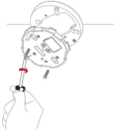
Una vez instalada la base de montaje con la fuente de alimentación en el techo, conecte el detector girándolo en el sentido de las agujas del reloj hasta que haga clic. Si falta la pila o está introducida de forma incorrecta, el detector de humo no podrá hacer clic en la base de montaje.
