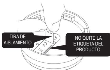
**Tenga en cuenta que:** La conexión por RF se realiza con el dispositivo alimentado solo con la pila. No es necesario que conecte la alimentación de red. La etiqueta del producto no debe quitarse, ya que contiene información importante sobre el mismo.
