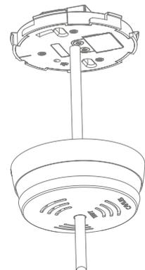
Conecte los 4 hilos a la fuente de alimentación: fase (L1), neutro (N), tierra (⏏), el cable de alimentación de la lámpara (L2).
