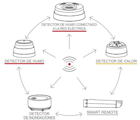
Todas las alarmas interconectadas de CAVIUS dentro de la familia de alarmas inalámbricas se pueden agregar al sistema, ya que se ejecutan en la misma frecuencia y usan el mismo protocolo de datos.
