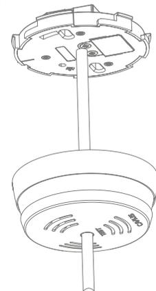
Raccordez les 4 fils à l'alimentation électrique : Phase (L1), neutre (N), terre (⏏), le fil d'alimentation de la lampe (L2).
