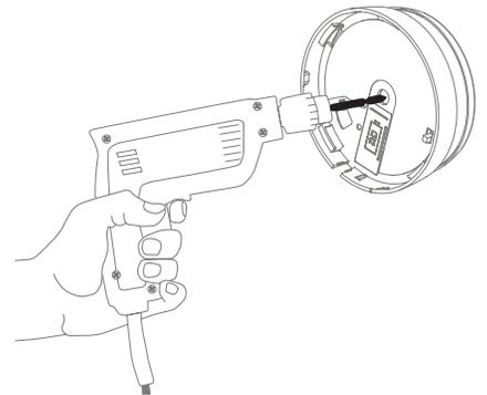
Installez l'alimentation dans le socle de montage ou en utilisant une boîte d'encastrement comme indiqué dans les options 1 & 2.
