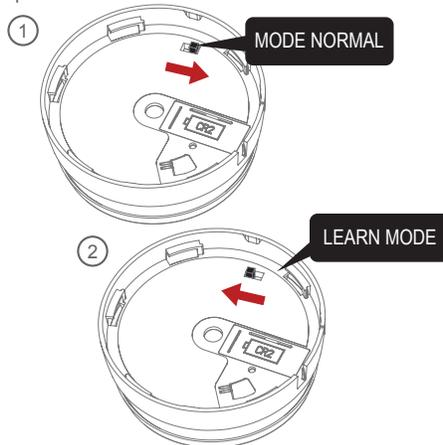
**A noter :** L'interrupteur situé à l'arrière du détecteur ne peut être positionné sur la position 'Learn mode' que lorsque le détecteur est séparé de son alimentation électrique. L'interrupteur se repositionne automatiquement sur la position 'Normal mode' lorsque la tête du détecteur est insérée sur son alimentation.
