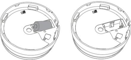
Insérez la pile en respectant les polarités. Fixez le détecteur sur l'alimentation en tournant dans le sens des aiguilles d'une montre jusqu'à ce qu'il clique, et testez le détecteur.
