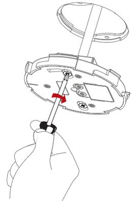
**A NOTER :** Le socle de montage n'est pas utilisé lorsque le détecteur est installé sur la boîte d'encastrement.
