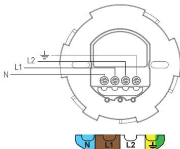
Raccordez les 3 fils à l'alimentation électrique : Phase (L1), neutre (N), terre (⏏).
