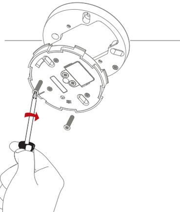
Une fois le socle de montage et l'alimentation électrique installés, fixez le détecteur en tournant dans le sens des aiguilles d'une montre jusqu'à ce qu'il clique. Si la pile est manquante ou mal insérée, il sera impossible de clipser le détecteur de fumée dans le socle de montage.
