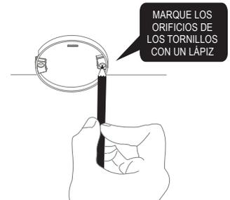
Use el anillo de la base de montaje para marcar los orificios de los tornillos en el techo o la pared.
