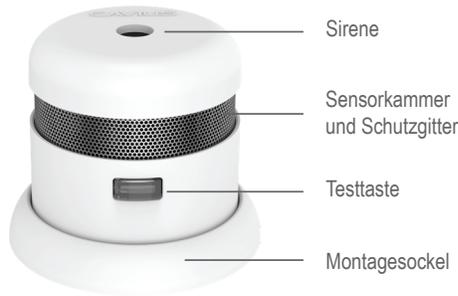
**Wartung:** Der Rauchmelder sollte einmal pro Quartal mit dem Staubsauger gereinigt werden und kann mit einem feuchten Tuch abgewischt werden (den Rauchmelder nicht öffnen). Überprüfen Sie den Rauchmelder mindestens einmal pro Quartal durch Druck auf den Testknopf. Der Melder sollte einen lauten Ton von sich geben.
