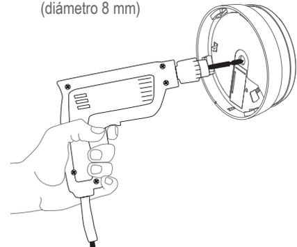
Instale la fuente de alimentación en el aro de la base de montaje o utilice la caja de derivación tal y como se muestra en la opción 1 y 2.
