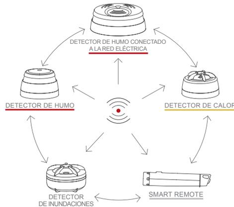
El detector de humo conectado a la red eléctrica se puede usar con los detectores de la familia de dispositivos inalámbricos CAVIUS: detectores de humo, calor, inundaciones, CO y de alimentación de red. Todos los detectores interconectados CAVIUS pertenecientes a la
