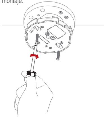
Una vez instalada la base de montaje con la fuente de alimentación en el techo, conecte el detector girándolo en el sentido de las agujas del reloj hasta que haga clic. Si falta la pila o está introducida de forma incorrecta, el detector de humo no podrá hacer clic en la base de montaje.
