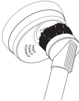
**NOTA:** Puede limpiar fácilmente la cámara del detector de humo mediante aspirador a través de los orificios preparados para ello en la tapa, y es posible probar los detectores presionando la tapa al mismo tiempo.
