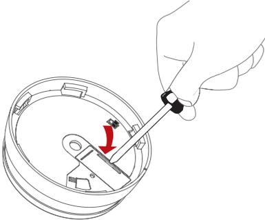
Sustituya la pila respetando su polaridad. Encaje el detector en la alimentación de red girándolo en el sentido de las agujas del reloj hasta que haga clic, y pruébelo.
