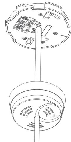
Conecte los 4 hilos a la fuente de alimentación: fase (L1), neutro (N), tierra (⏏), el cable de alimentación de la lámpara (L2).
