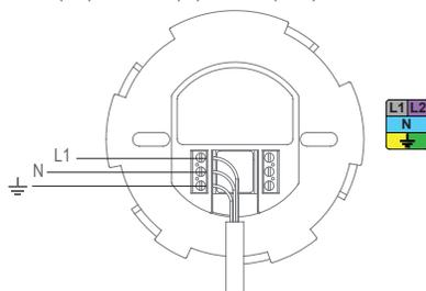
Atornille la fuente de alimentación sobre la caja de derivación.
