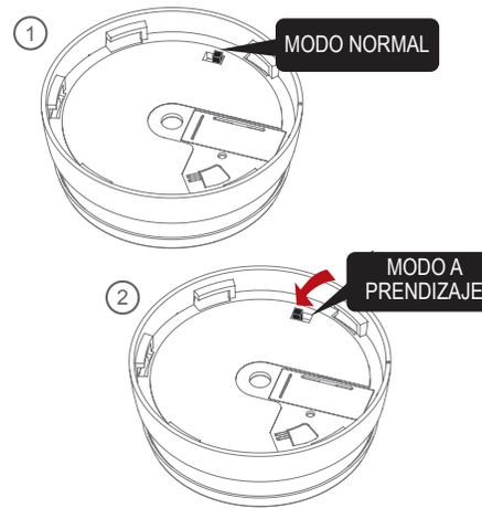
**Tenga en cuenta que:** El selector de aprendizaje situado en la parte trasera del detector solo puede estar en la posición de aprendizaje cuando el detector está desconectado de la fuente de alimentación. El selector de aprendizaje se situará automáticamente en la posición normal cuando el cabezal del detector esté conectado a la fuente de alimentación.
