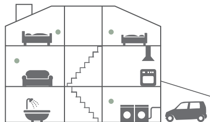
● Emplacements recommandés de détecteur de CO
