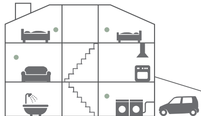
● Emplacements recommandés de détecteur de CO
