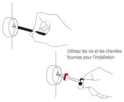
Fixez le détecteur en tournant dans le sens des aiguilles d'une montre.
